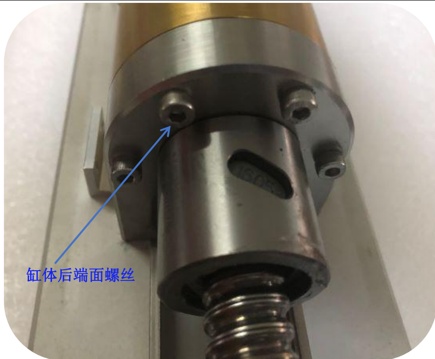
图 9 拆除缸体后端面螺丝
