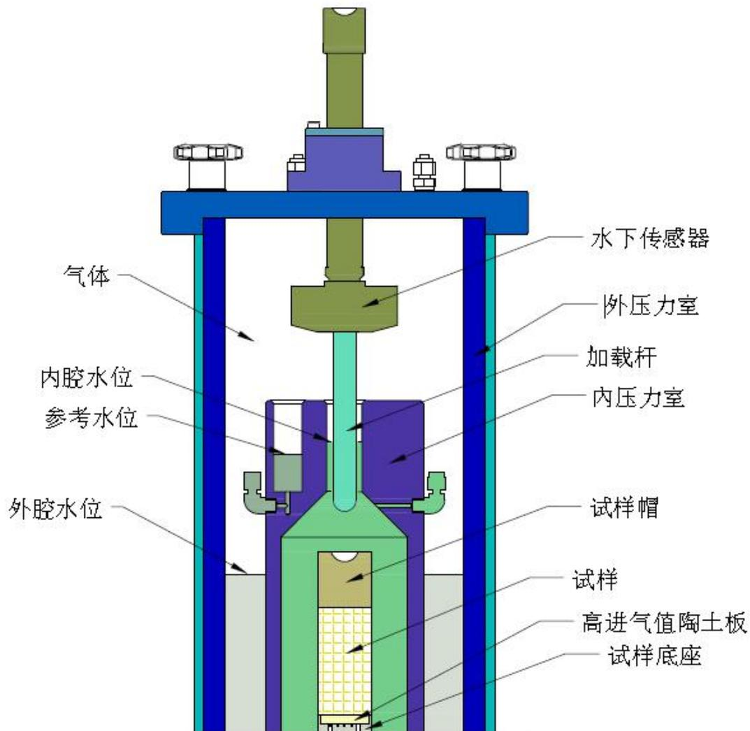
总体积变化测量系统基本原理是，通过采集内压力室水位与参考水位之间的压差来测量非饱和土试样的总体积变化。在三轴设备的外压力室中，将内压力室密封到基座上。高精度 DPT 连接到内压力室和参考管，采集由于试样体积变化引起的内压力室内部水压变化与参考管中恒定水压之间的压差变化。在试验期
