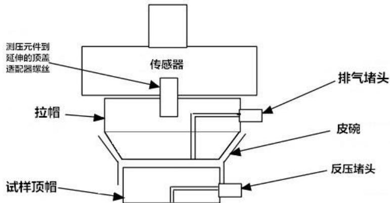
在不使用外置传感器的情况下，使用内部力传感器测量(独立于围压的力)试样上的轴向应力(kN)为：
