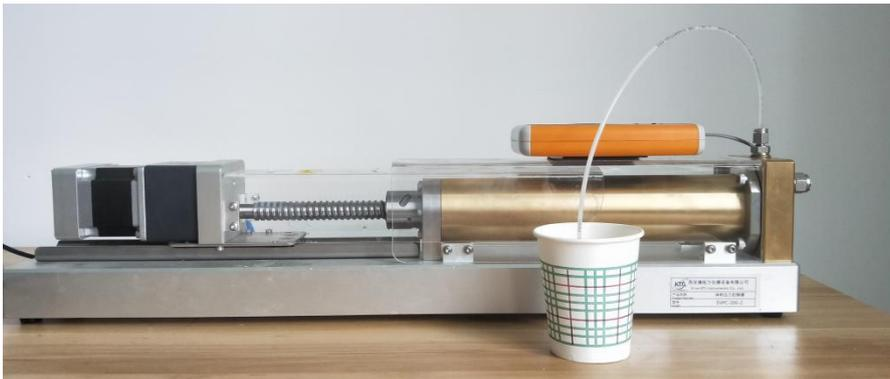
(2) 在键盘上选择 MENU-Fill/Empty-Fast Empty，控制器将快速清空，直到它安全的达到它自己的限位，这时体积压力控制器里的水与空气都已清空。
